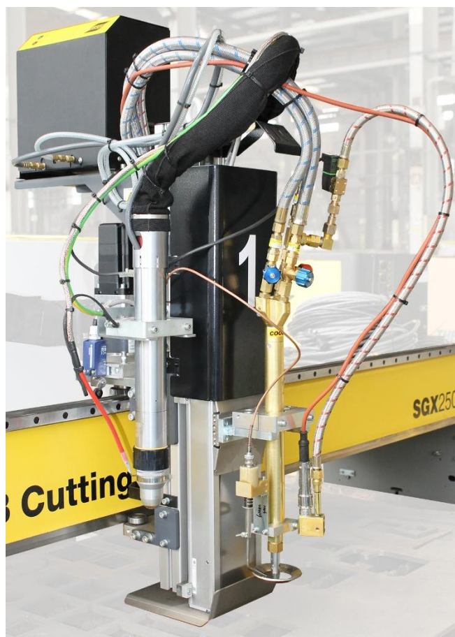
Суппорт со сменными резаками, подготовленный к газовой резке
