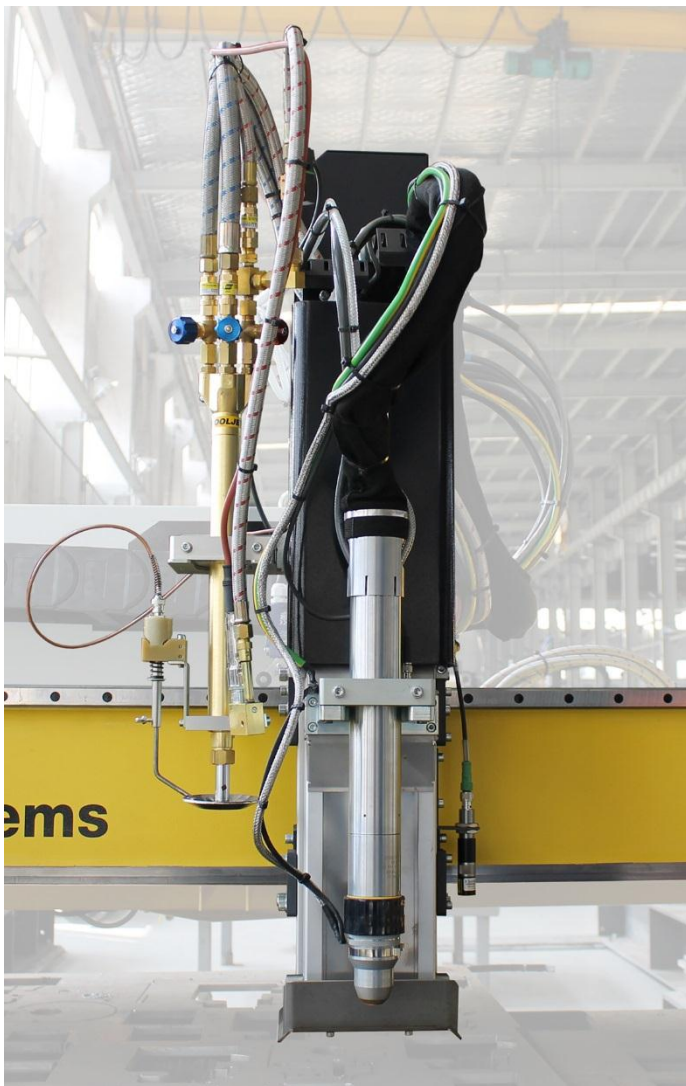
Станция сменных резаков, подготовленная к плазменной резке
