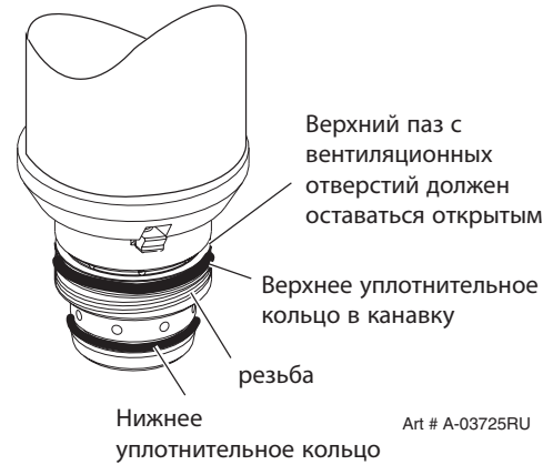
Уплотнительное кольцо головки горелки
